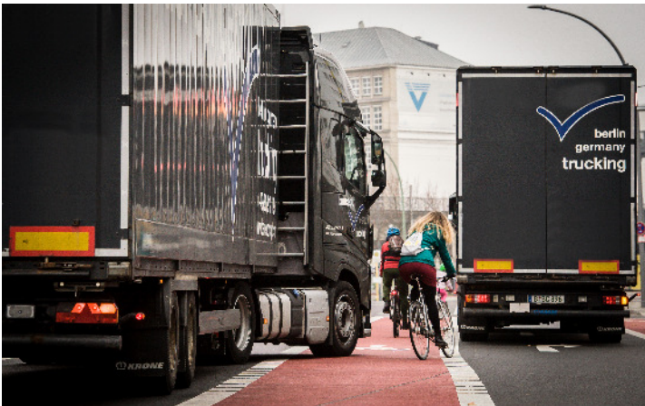
schlechte Radverkehrsführung auf der Fahrbahn
